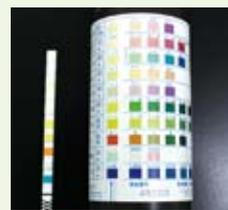
装置の中で試験紙を使い変色の度合いを確認します
